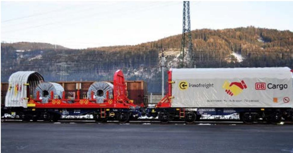
InnoTainer-Coils, Transport von hochwertigen Stahlcoils (Bild: Innofreight Solutions GmbH)
