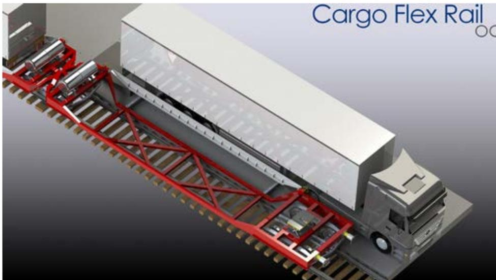
Schienenfahrzeugwagen zur Horizontalverladung
