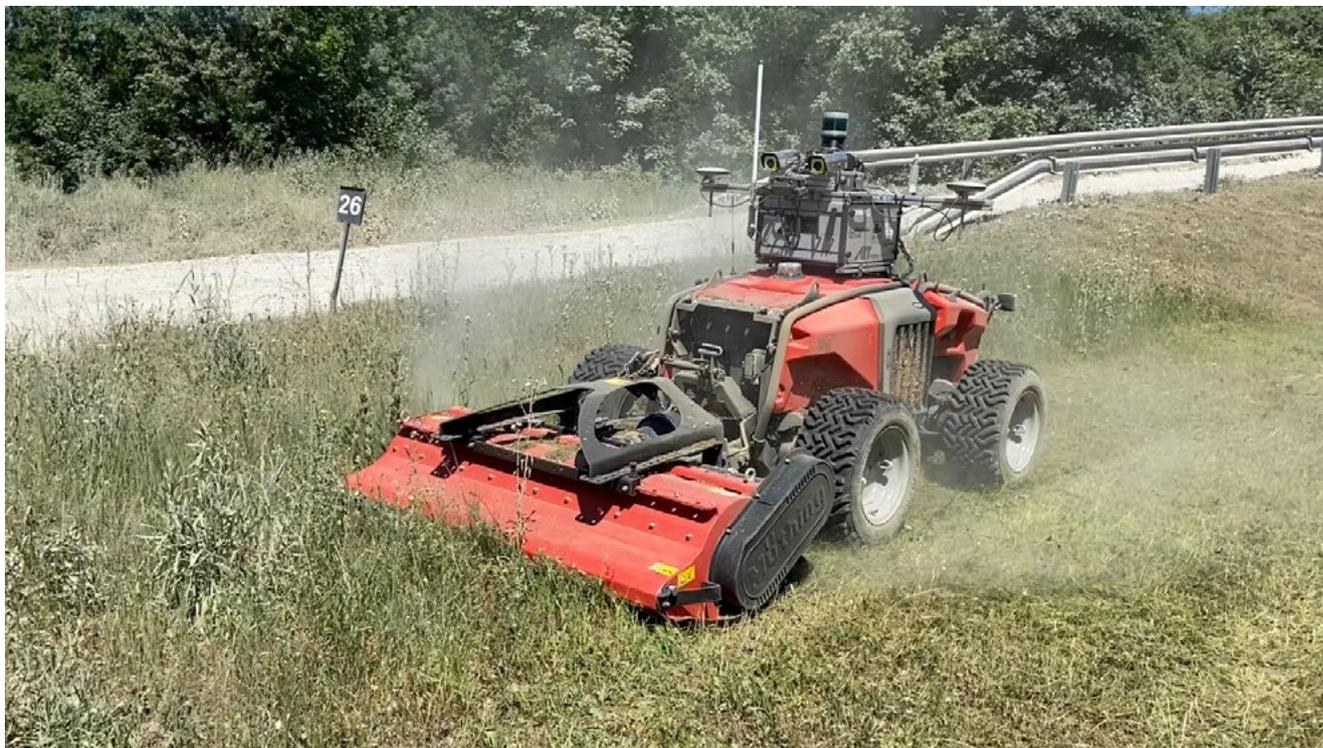
Feldversuche in SMARTER mit dem automatisierten Geräteträger Metron P48.
