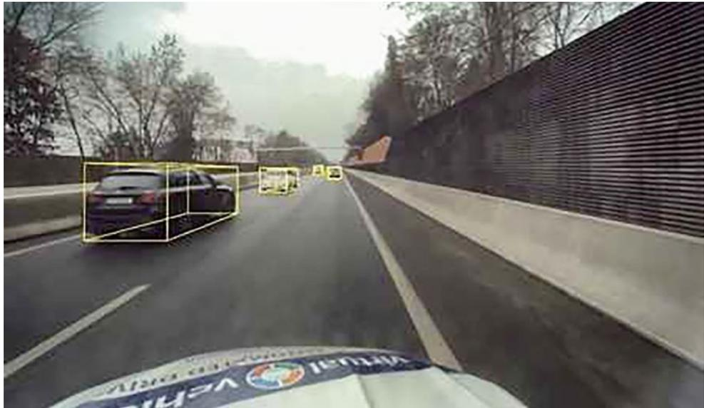
Ziel von DGT ist es, den Entwicklungsprozess von ADAS/ADF auf das Niveau der Fahrzeugentwicklung zu heben, indem die Umgebungsdaten (Ground Truth) zuverlässig durch ein hochauflösendes Messsystem aufgenommen und erkannt werden. Der Entwurf und die Entwicklung eines solchen Sensorsystems (Referenz-Messsystem) und die Umsetzung eines funktionalen Prototyps sind Fokus dieses Forschungsprojekts.
