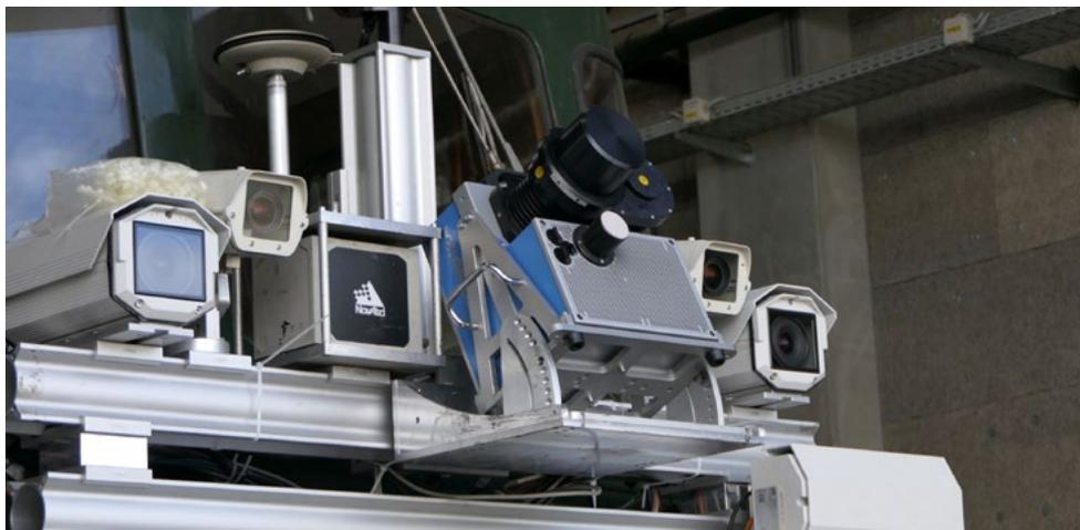
Mobile Mapping System von iNovitas AG zur 3D-Bild- datenerfassung.
