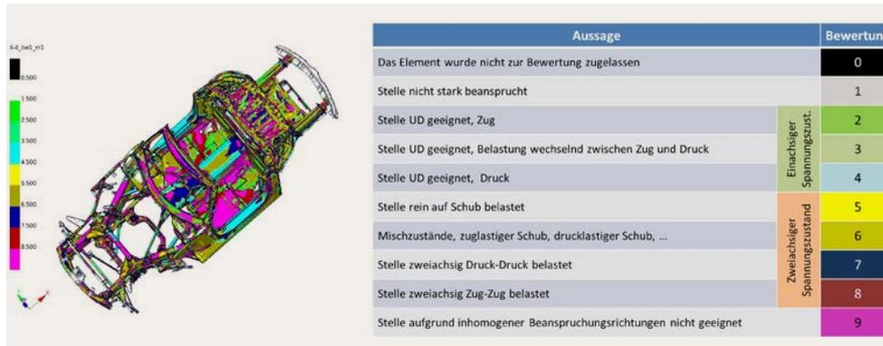
Abbildung 87: Links: Darstellung des Potentials für den Einsatz von anisotropem Werkstoff; rechts: Bewertungsschema für alle Stellen am Bauteil hinsichtlich der Eignung für Composite-Werkstoffe mit DU-Lagen
