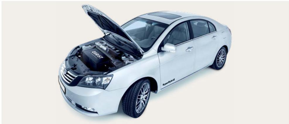
Ziel dieses Projektes war die Entwicklung und Darstellung eines hocheffizienten und kostengünstigen Plug-in-Seriellhybridsystems (HyperHybrid) für die Serienanwendung in Pkw. Der HyperHybrid ermöglicht einen emissionsfreien Betrieb des Fahrzeuges innerorts durch batterieelektrischen Betrieb und einen verbrauchsoptimierten hybrid-elektrischen Betrieb außerorts durch den Einsatz eines Zero-Vibration-Generators (ZVG).
