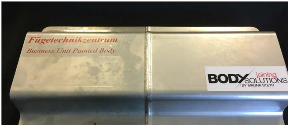
Abbildung 85: Heißbrissfrei verschweißte Stahl- und Aluminiumbleche mit M-B-D-Schweißnaht
