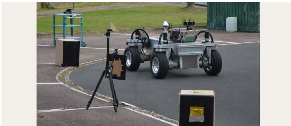
Abbildung 98 SPIDER-Messfahrt am Testgelände mit Infineon-Sensoren, Testobjekten und V2X-Kommunikation mit Siemens-Road-Side-Unit
