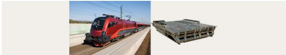
Konventionelle Heizungs-, Lüftungs- und Klimaanlage (HLK) sind im Schienenfahrzeugbereich ein wesentlicher Energieverbraucher (30 %) und Verursacher von Treibhausgasemissionen. HLK-Anlagen müssen vor allem Komfortkriterien von Passagieren in einem breiten Betriebsbereich erfüllen, aber für Bahnbetreiber auch entsprechend kosteneffizient und umweltfreundlich sein.
