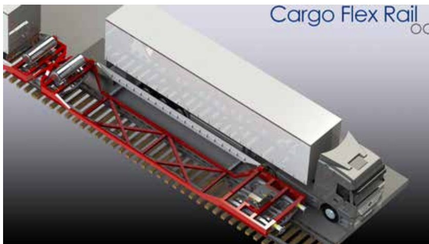
Abbildung: Schienenfahrzeugwagen zur Horizontalverladung
