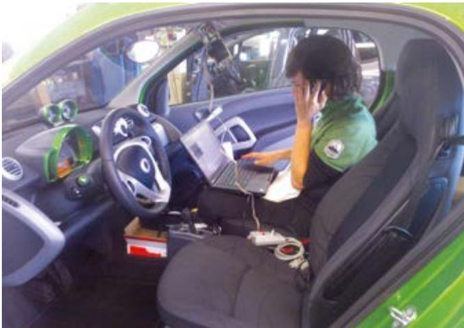
Abbildung: Auswertungsarbeiten an der On Board Unit eines E-Caruso Testfahrzeugs
