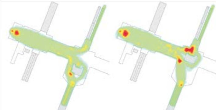
Abbildung: Vergleich der Personendichte in der Station Heiligenstadt mit 6000 P/h: Bei der linken Positionierung des Lifts gibt es kleine Bereiche mit hoher Dichte, bei der rechten Positionierung große Flächen mit hoher Dichte.
