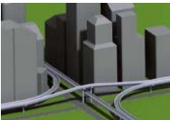
Abbildung: 3D-Darstellung eines planfreien Knotenpunktes
