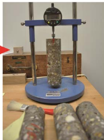
Abbildung 33: Methode zum Nachweis des treibendem Angriffes nach dem SVA-Verfahren; links: Lagerung; rechts: Messung der Längenänderung [49]
