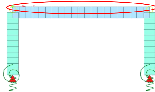
Abbildung 5: Lage der Knoten in der Fahrbahnplatte
