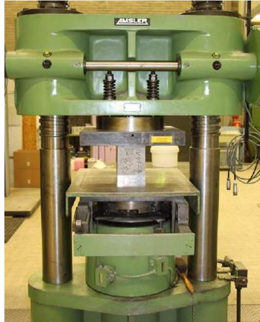
**Abb. 7:** Prüfanordnung zum Druckversuch
