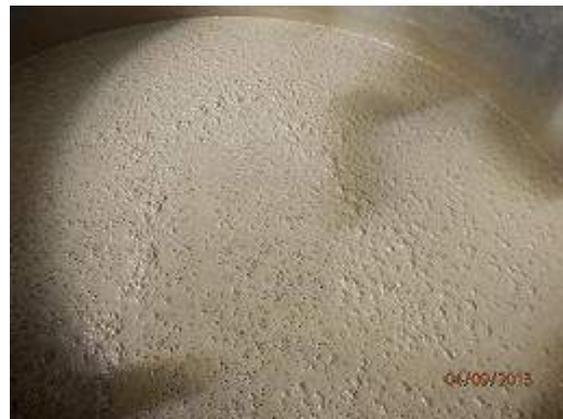
**Abb. 14:** Herstellung der Betonmischungen im Zwangsmischer
