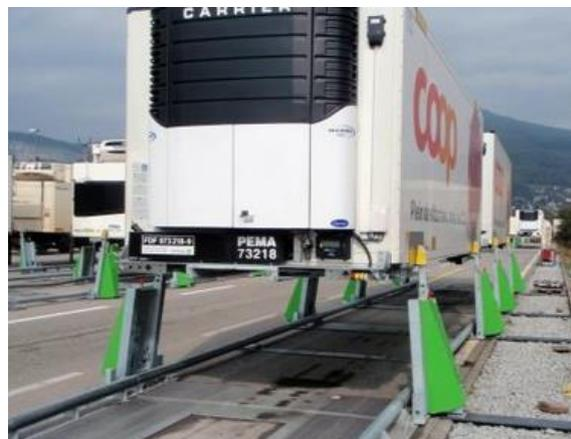
Abbildung 4: Containerstation von Innovatrain; Quelle [www.innovatrain.ch](http://www.innovatrain.ch)
