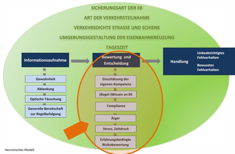
**Abbildung 5: Heuristisches Modell zu Fehlverhalten an Eisenbahnkreuzungen; Bewertung und Entscheidung, Entscheidungsfehler und mögliche Erklärungen**
