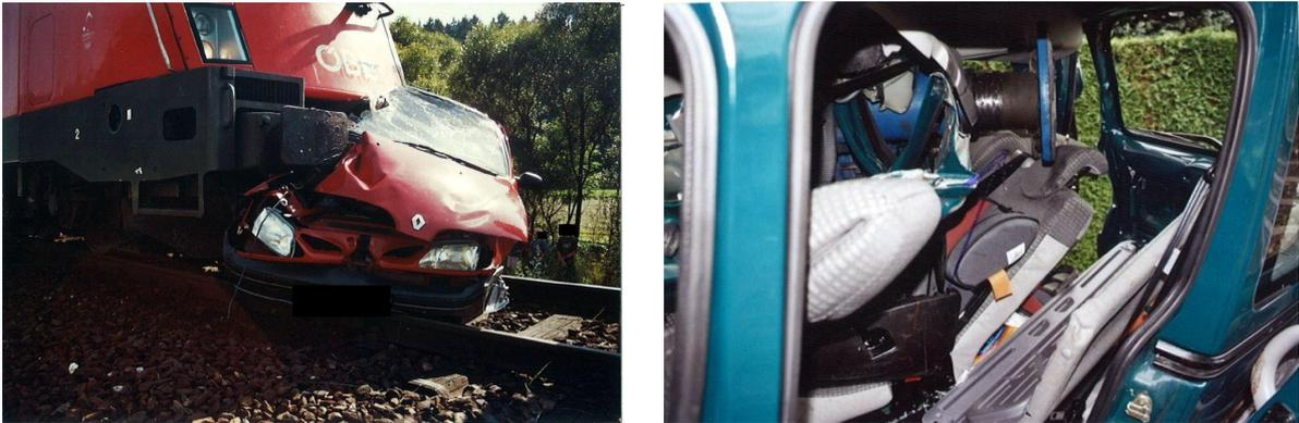
**Abbildung 9: Tiefe Intrusionen in die Fahrgastzelle bei seitlichen Kollisionen von PKW und Triebwagen**
