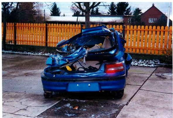
**Abbildung 14: Kreuzungsübersicht, Endposition und Beschädigungsbild des PKW und Triebwagen bei einem Eisenbahnkreuzungsunfall ohne Sichteinschränkung**
