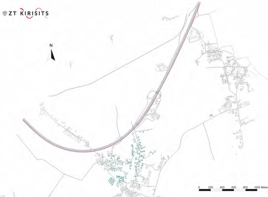
**Abbildung 20: Lageplan zu Beispiel B mit blau gekennzeichneten schutzwürdigen Wohngebäuden und der rot gezeichneten Basislinie für die Lärmschutzwand parallel zum Straßenverlauf.**
