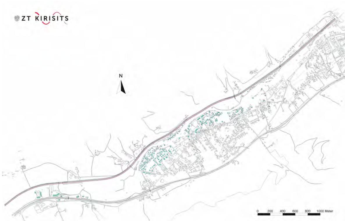
**Abbildung 36: Lageplan zu Beispiel C mit blau gekennzeichneten schutzwürdigen Wohngebäuden und der rot gezeichneten Basislinie für die Lärmschutzwand parallel zum Straßenverlauf.**
