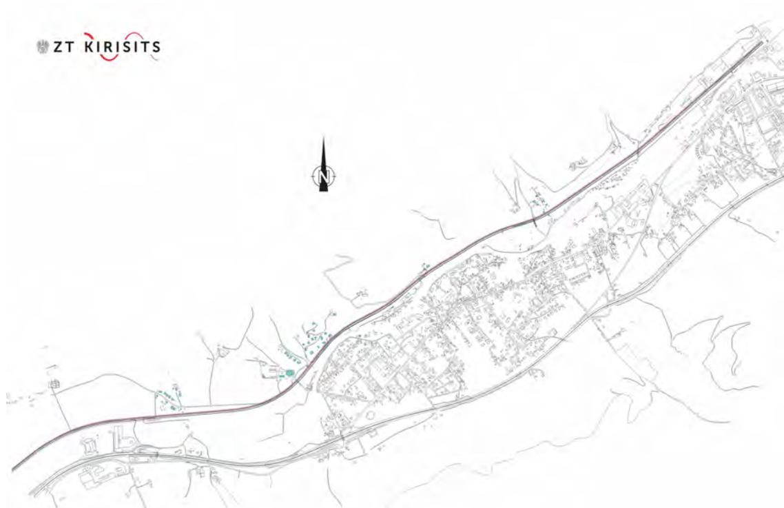
**Abbildung 43: Lageplan zu Beispiel D mit blau gekennzeichneten schutzwürdigen Wohngebäuden und der rot gezeichneten Basislinie für die Lärmschutzwand nördlich, parallel zur Schienenstrecke.**
