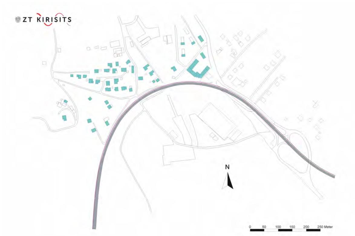
**Abbildung 11: Lageplan zu Beispiel A mit blau gekennzeichneten schutzwürdigen Wohngebäuden und der rot gezeichneten Basislinie für die Lärmschutzwand parallel zum Straßenverlauf.**
