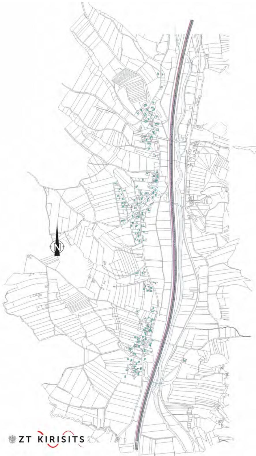
Abbildung 49: Lageplan zu Beispiel E mit blau gekennzeichneten schutzwürdigen Wohngebäuden und der rot gezeichneten Basislinie für die Lärmschutzwand parallel zum Straßenverlauf.
