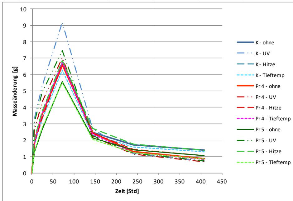
Abbildung 14: Wasseraufnahme nach 6, 24 und 72 Stunden und Rücktrocknung nach 144, 240 und 408 Stunden ohne bzw. nach UV-, Hitze- oder Tieftemperatur Beanspruchung
