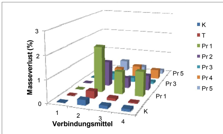
**Abbildung 9:** Ergebnisse der ermittelten Masseverluste (%) der verschiedenen Verbindungsmittel in der unbehandelten Buchenkontrolle (K), der mit Kreosot (T) sowie der mit den 5 Schutzmitteln (Pr 1 – Pr 5) imprägnierten Proben
