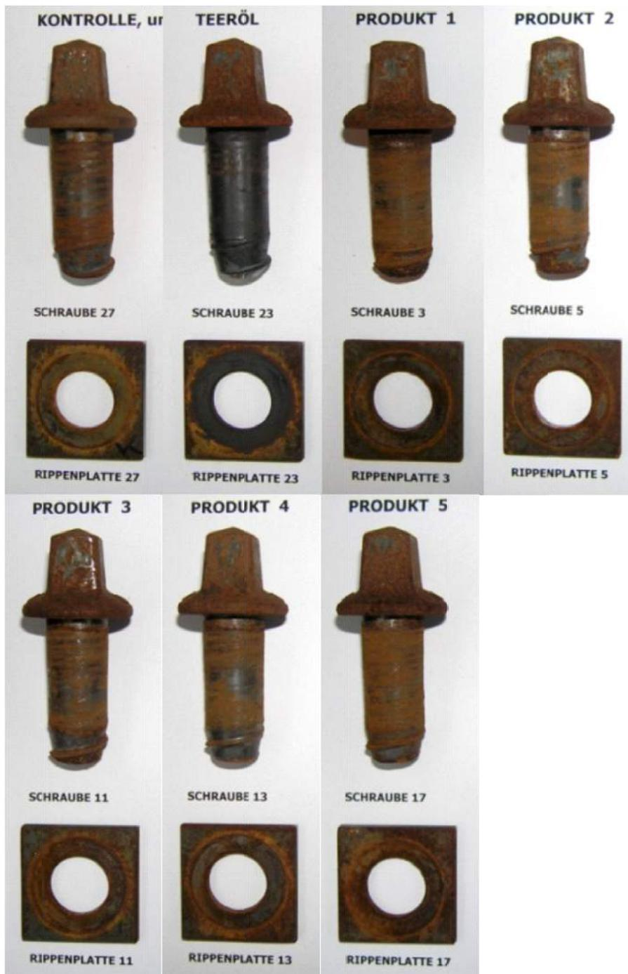
Abbildung 11: Schwellenschrauben und „Rippenplatten“ nach 6 Monaten Freilandexposition
