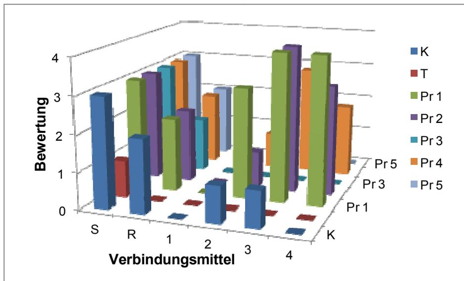
**Abbildung 8: Ergebnisse der visuellen Bewertung der Korrosion der verschiedenen Verbindungsmittel in der unbehandelten Buchenkontrolle (K), der mit Kreosot (T) sowie der mit den 5 Schutzmitteln (Pr 1 – Pr 5) imprägnierten Proben**
