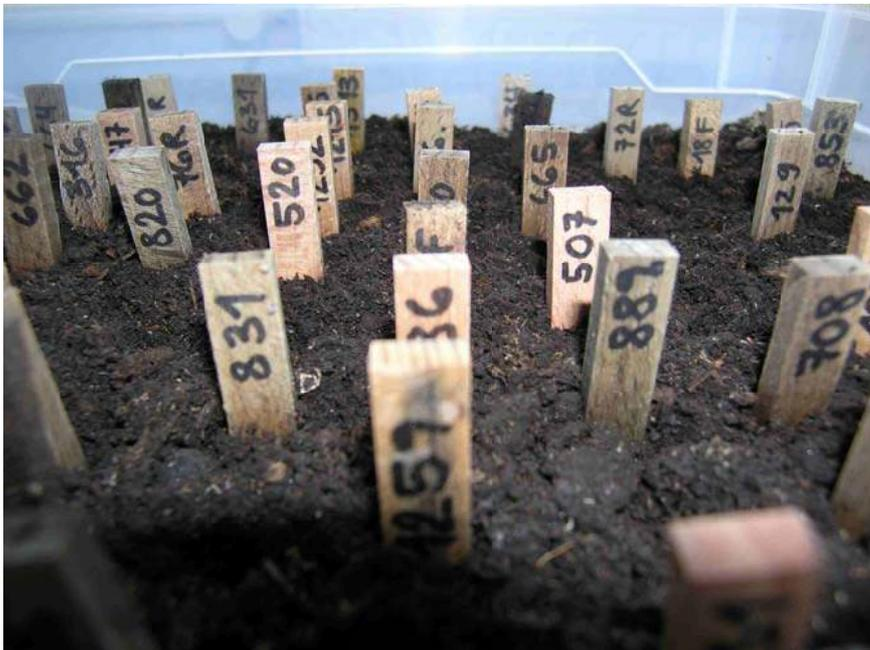
**Abbildung 3: Beispiel der Versuchsmethode zur Untersuchung gegenüber Moderfäulepilzen**
